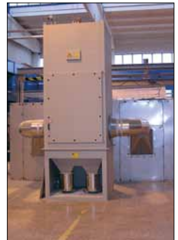
Schleifkabinenabsaugung durch einen VARIO 3 eco
