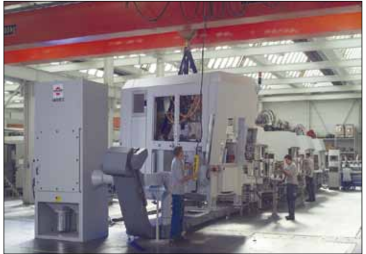
VARIO 2 eco für die Späneabsaugung einer Fertigungslinie
