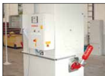
Explosionsunterdrückung durch automatische Löschmitteleinbringung
